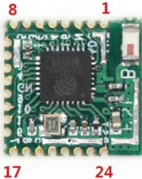
图 3 模块引脚顶视排列图
