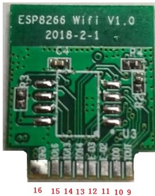
图 4 模块引脚底反面排列图
